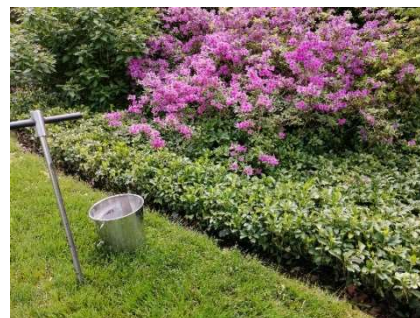
Prise d'échantillon de sol urbain sur Cologny pour des analyses chimiques, physiques et biologiques en laboratoire
